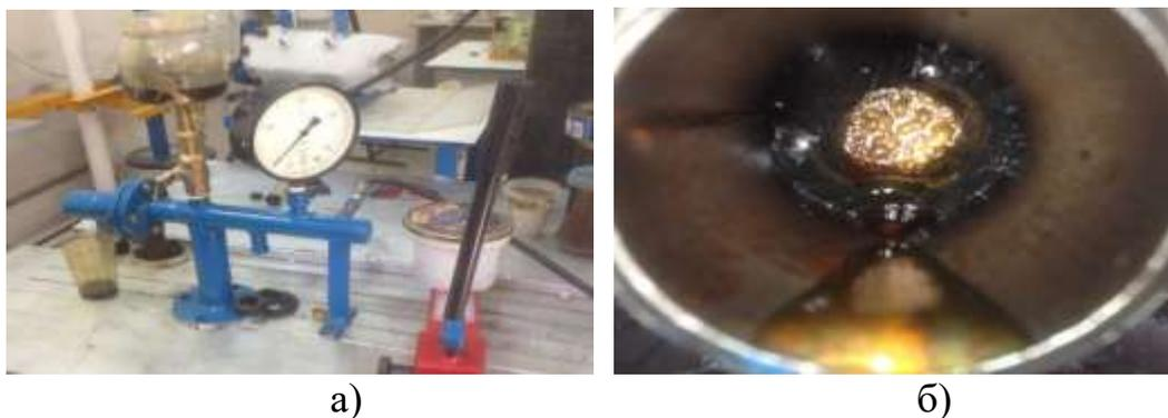
Рисунок 18 – а) устройство отталкивания нефти водой в насыщенном нефтью керне и б) вид выталкиваемой воды-нефти
